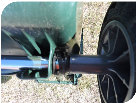
Ruedas insonorizadas mediante compensador
