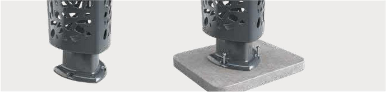
Este modelo permite su instalación directamente al suelo a través de 3 puntos de anclaje con tacos de expansión con tornillo M8X80.
